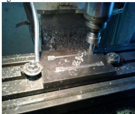
Figura 1. Molde com as duas cavidades.
